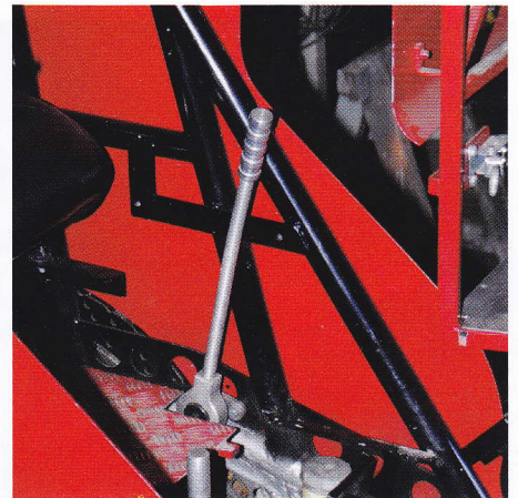
« Het lange hendel tegen het spatbord bedient de prise-asrem, waarmee het schakelen een stuk soepeler gaat.
