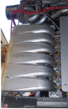
« Elk team heeft zijn eigen filosofie over het inlaathuis. Bij deze International 1066 zijn het hoge pijpen en geen komvormige inlaat.
