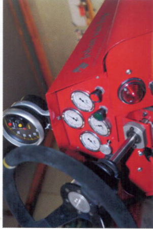
« Het dashboard zoals het van origine ook is op een International 1066. Alleen de meterjes op D'n Aerdvruter zijn anders.
