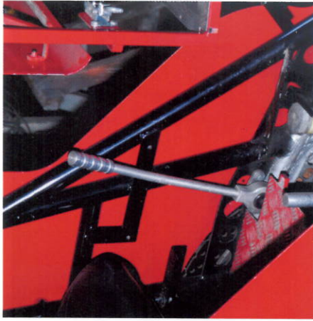
« Het lange hendel tegen het spatbord bedient de prise-asrem, waarmee het schakelen een stuk soepeler gaat.
