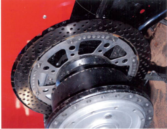
« De 'Vruter'-mannen tekenen en maken bijna alles zelf. Een fraai stukje freeswerk is de lichtgewicht remschijf.
