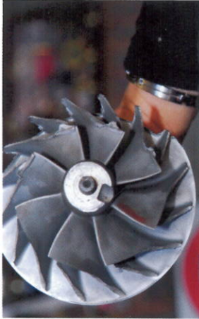
« De boosdoener van Zwolle. Duidelijk te zien zijn de weggevreten vanen van het turbine wiel als gevolg van een kromme turbo-as.
